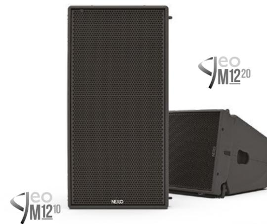
Fabriqués en composite de polyuréthane léger, les modules pour line array GEO M12 mesurent 700 x 370 x 446 mm (L x H x P), pour un poids de 34 kg. Ils utilisent un haut-parleur de grave 8 ohms à longue excursion et aimant néodyme de 12" (305 mm) de diamètre, équipé du dispositif Phase Directivity Device, et un moteur d'aigu à bobine mobile 3 pouces et sortie 1,4 pouce monté sur un guide d'ondes BEA/FEA optimisé HR Wavesource™.
