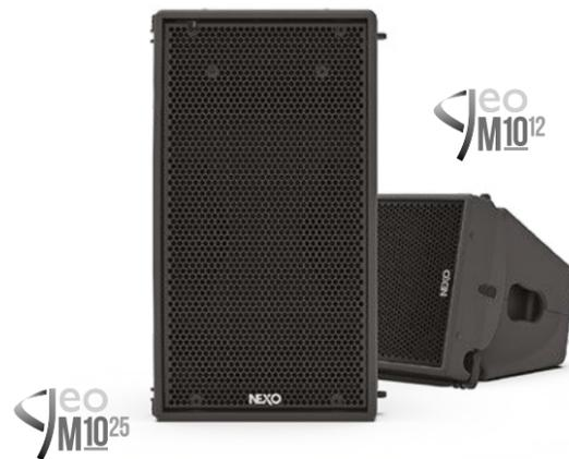
Fabriqués en composite de polyuréthane léger, les modules pour line array GEO M10 mesurent 531 x 288 x 355 mm (L x H x P), pour un poids de 21 kg. Ils utilisent un haut-parleur de grave à longue excursion et aimant néodyme de 10 pouces (254 mm) de diamètre, d'impédance 8 ohms, équipé du dispositif Phase Directivity Device, et un moteur d'aigu à bobine mobile 2,5 pouces et sortie 1,4 pouce monté sur un guide d'ondes BEA/FEA optimisé HR Wavesource™.
