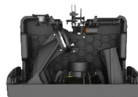
Vue interne du module GEO M10 avec, de gauche à droite, le guide d'ondes HRW™, le haut-parleur à aimant néodyme de 10 pouces avec pièce de mise en phase DPD™ et l'évent incurvé en forme de V.
