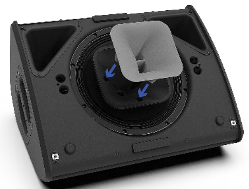
Une fois la grille retirée, des flanges magnétiques supplémentaires peuvent rapidement être installés de manière à changer la directivité pour passer de 60 x 60 à 90 x 40.
