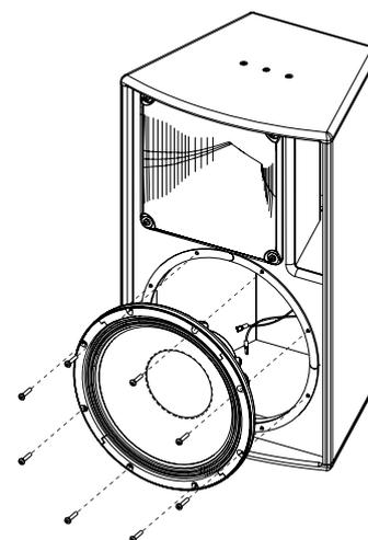
Retirer les 4 vis situées à l'arrière d'ePS12 puis les 4 vis qui maintiennent le pavillon. Retirer l'ensemble du pavillon.
