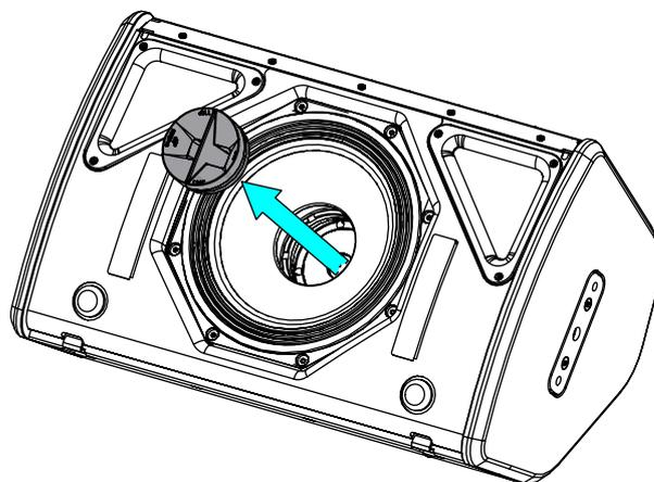
Placer le pavillon, orienter le si nécessaire.
