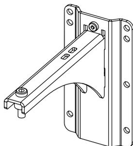
Fixer la platine murale. Placer le bras sur la platine, bloquer avec la vis fournie.
