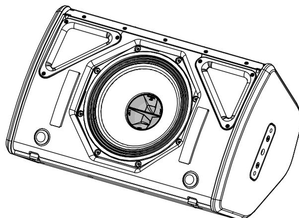
Lors du remontage de la grille, vérifier qu'elle soit bien engagée dans la lame supérieure avant de la fermer avec les crochets, visser.
